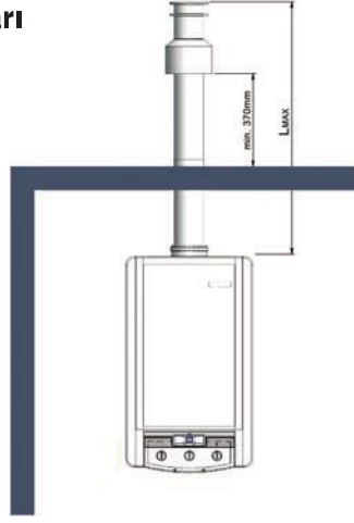
Dikey Hermetik Baca Uygulaması (Dirseksiz L max . Mesafesi : 8 m , Ø 60/100) 24kW modellerde (Dirseksiz L max . Mesafesi : 5 m , Ø 60/100) 30kW modellerde
