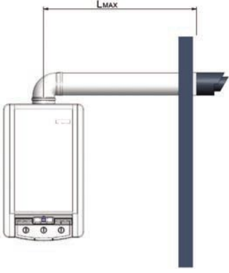
Yatay Hermetik Baca Uygulaması (Tek Dirsekle L max . Mesafesi : 7 m , Ø 60/100) 24kW modellerde (Tek Dirsekle L max . Mesafesi : 4 m , Ø 60/100) 30kW modellerde
