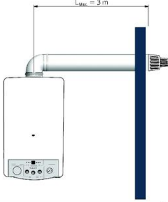
Yatay Hermetik Baca Uygulaması (Tek Döşekle L_{Max} Mesafesi : 3 m, \phi 60/100)
