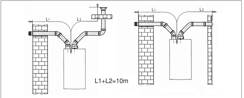
C5 tipi bacalarda, atık gaz ve temiz hava terminalleri binanın karşıt duvarlarına tesis edilmelidir.
