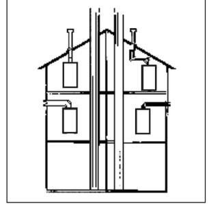
Atık gaz bina dışına çıkarıldığında, baca duvarda en az 18mm dışarı çıkarılmalı ve su sızmasının engellenmesi için etrafı sızdırmaz şekilde kapatılmalıdır. Bacanın bina dışına çıkarıldığı tahliye deliği, kapı, pencere ve/veya havalandırma menfezlerinden en az 0,7 metre uzağında olmalıdır.
