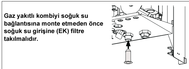
Şekil 29 Filtrenin takılması
